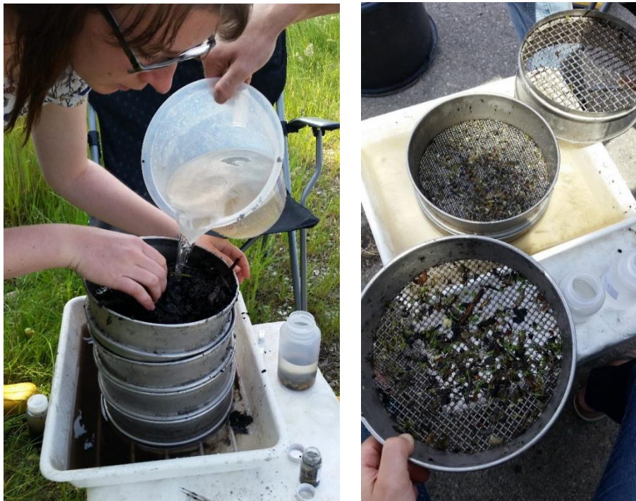
Abb. 6: Die Makrozoobenthos-Probe wird durch das Kolonnensieb gespült (links). Drei verschieden feine Siebteile des Kolonnensiebs (rechts).
