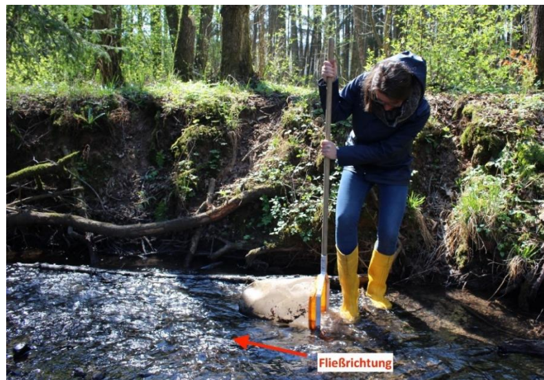
Abb. 5: Entnehmen einer Kescher-Probe in einem Bach mittels „Kick-Sampling“.
